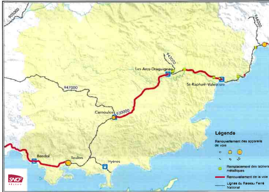
Travaux de renouvellement des éléments constitutifs des voies entre 2018 et 2023
