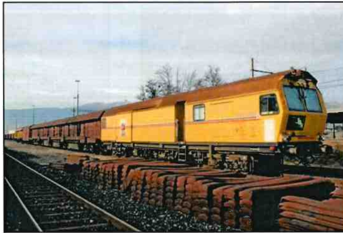
Train meuleur de rails (Scheuchzer S.A.)
